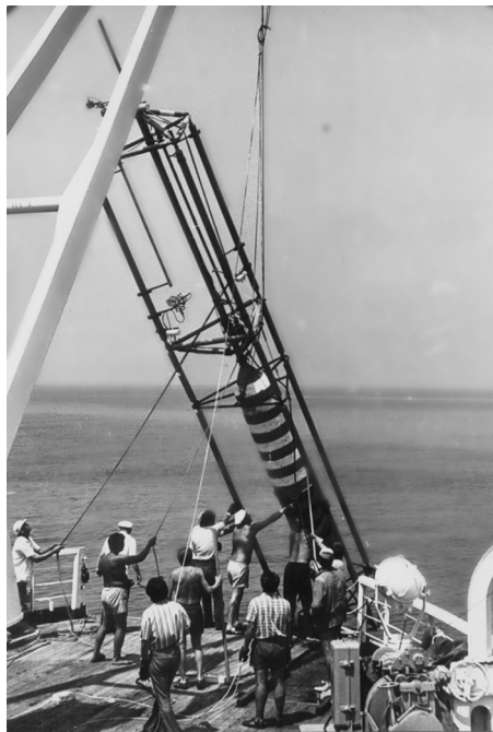
Рис. 3. Плавающая градиентная станция для определения передачи энергии ветра в поверхностном слое воды
