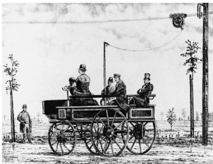
Рис. 1. Электромотор, прообраз современного троллейбуса. Линия протяженностью 540 м действовала в 1882 г. полтора месяца
